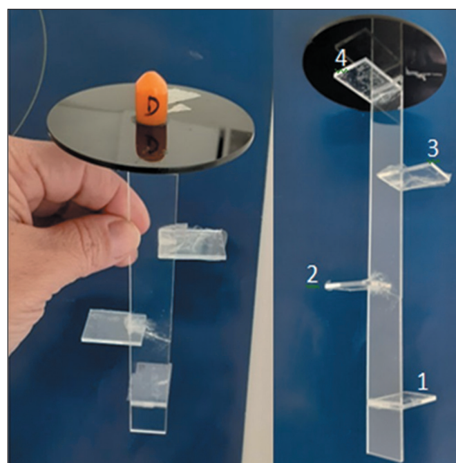
Figura 2. Imagem da régua dosimétrica, confeccionada em polimetilmetacrilato.
